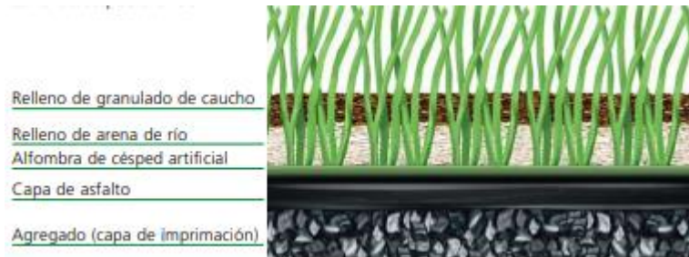
Figura 1 Capas y materiales para césped artificial (7).
